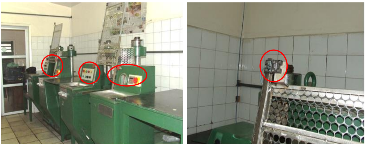
Figuras 7 e 8: Botões de partida e parada, botão de emergência, botão reset e comandos bi manual (simultâneo); e Sensor magnético de segurança para desarme. Fonte: Arquivo Pessoal.
