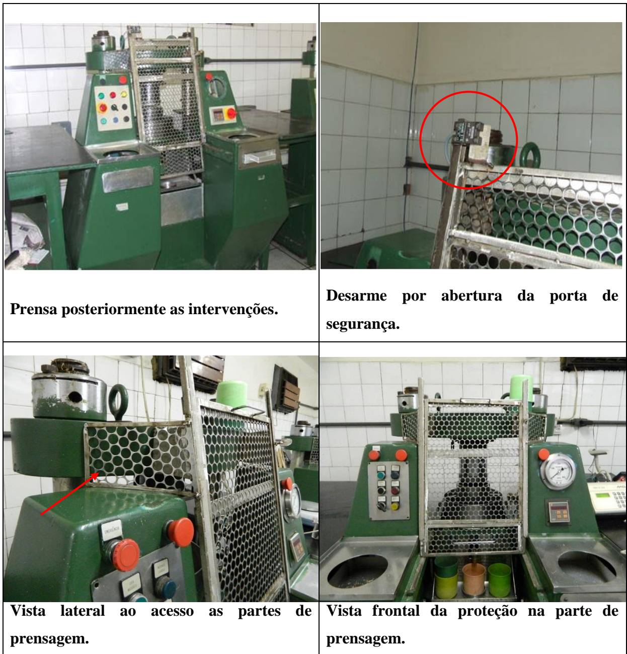
Figura 6: Prensas hidráulicas posteriormente às intervenções aplicadas. Fonte: Arquivo Pessoal
