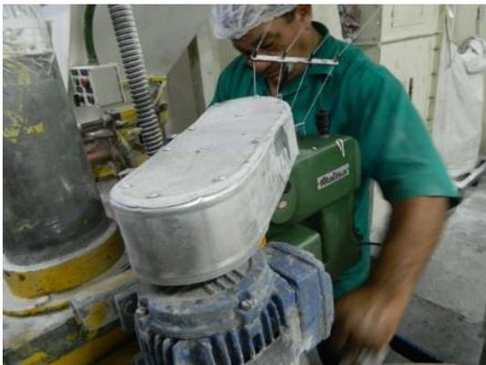
Figura 10– Vista da proteção entre o motor e maquina.
