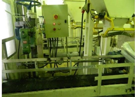
Figura 9– Quadro de comando próximo ao operador.
