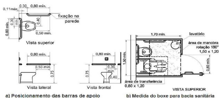
Figura 6: Localização das barras de apoio e boxe para bacia sanitária acessível Fonte: ABNT NBR 9050 (2004, p. 67-70)
